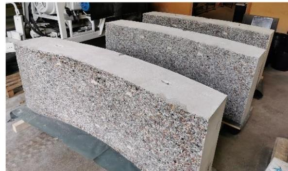
Hochdruckwassergestahlte Unterkonstruktionen für Brandversuche (KOINOR, 2021)
