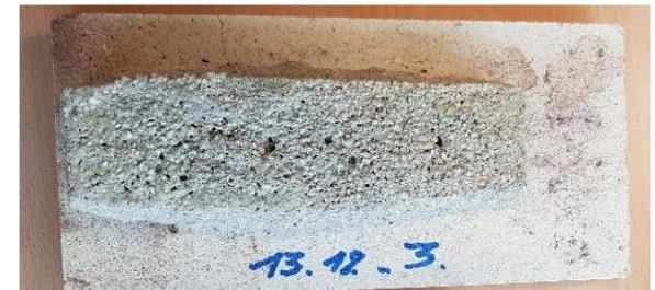
Detail: Sinterung der Probekörper (KOINOR, 2019)
