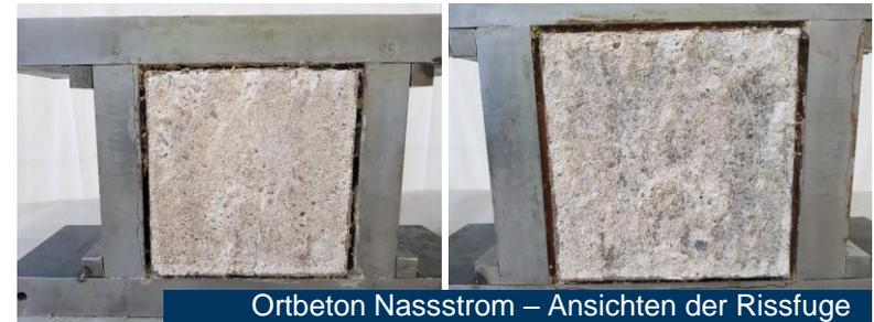
Ortbeton Nassstrom – Ansichten der Rissfuge
