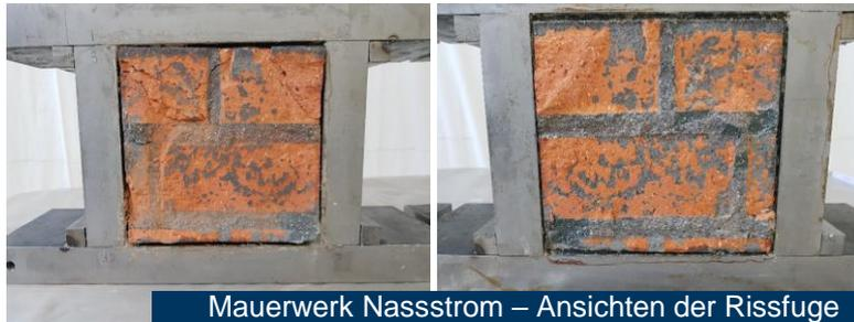
Mauerwerk Nassstrom – Ansichten der Rissfuge
