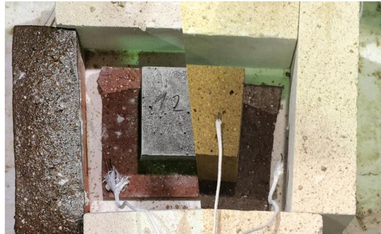
Probe des Geopolymerbetons vor und nach Temperaturexposition
