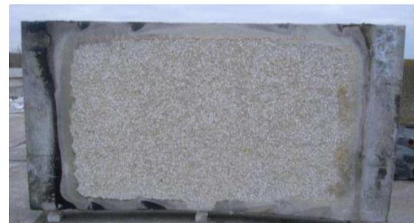
Betonoberfläche nach Brand, mit PP-Fasern
